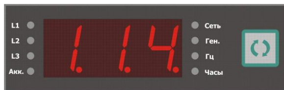
Рис. 5.6. Пример: параметр №114, доступный для редактирования значения.
