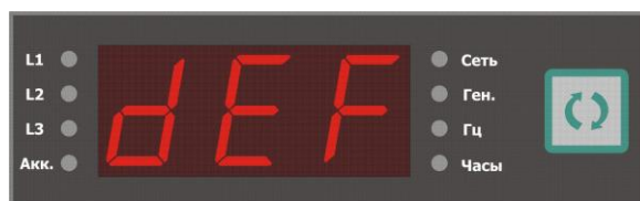
Рис. 5.8. Индикация установки параметров по умолчанию.
